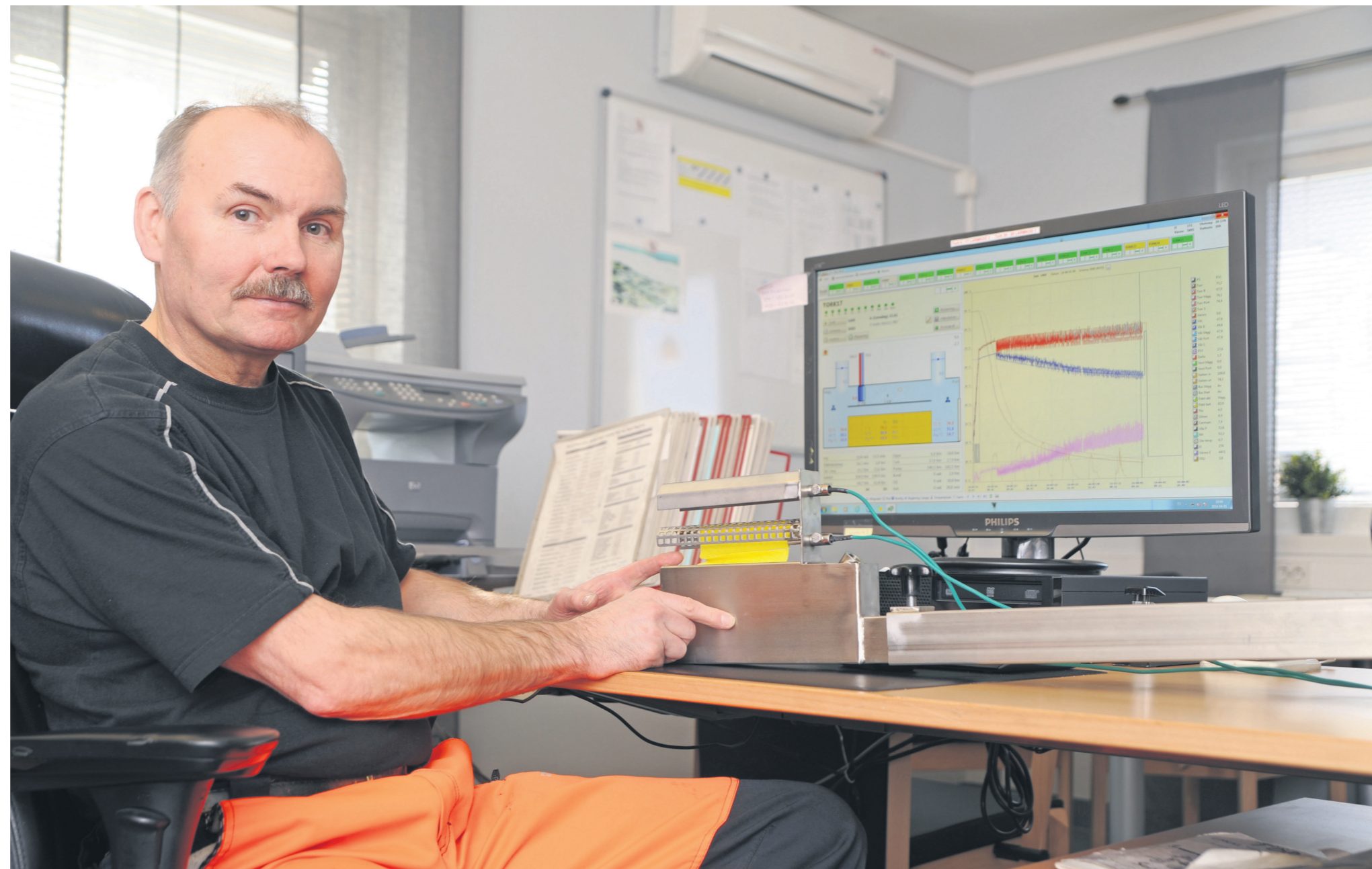
Kenneth Öhman, Torkansvarig hos Setra Malå, visar en torr- och våttemperaturgivare som är standard i virkestorkar och en komponent i den nya fuktkvotsmätaren.
